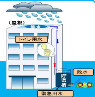
貯留槽に溜めた雨水を トイレ用水・散水等に利用
