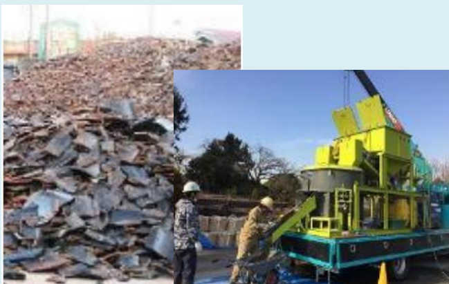
▲ 車載式舗装材製造プラント「モバコン」
